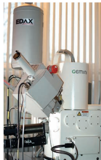
Rys. 1. Skaningowy mikroskop elektronowy Supra 35 firmy Zeiss wyposażony w detektory EDS oraz WDS firmy EDAX (Laboratorium Badania Materiałów Inżynierskich i Biomedycznych)
