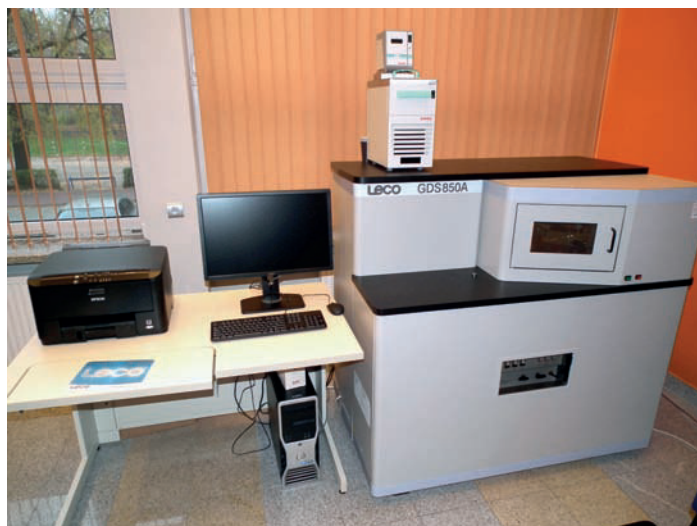
Rys. 7. Widok emisyjnego spektrometru optycznego z wyładowaniem jarzeniowym GDS850A firmy Leco, znajdującego się w Instytucie Materiałów Inżynierskich i Biomedycznych Politechniki Śląskiej w Gliwicach
