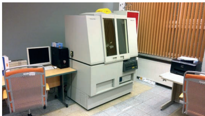
Rys. 1. Dyfraktometr rentgenowski X'Pert Pro MPD firmy Panalytical, znajdujący się na wyposażeniu laboratorium Instytutu Materiałów Inżynierskich i Biomedycznych Wydziału Mechanicznego Technologicznego Politechniki Śląskiej w Gliwicach
