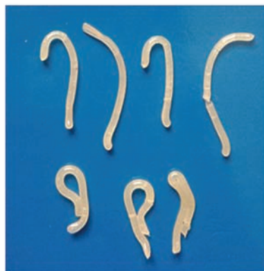
Rysunek 1. Odcinki pozyskane w trakcie oznaczania wskaźnika szybkości płynięcia PELD; próba: a) I; b) II
