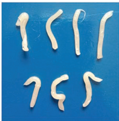
Rysunek 1. Odcinki pozyskane w trakcie oznaczania wskaźnika szybkości płynięcia PELD; próba: a) I; b) II
