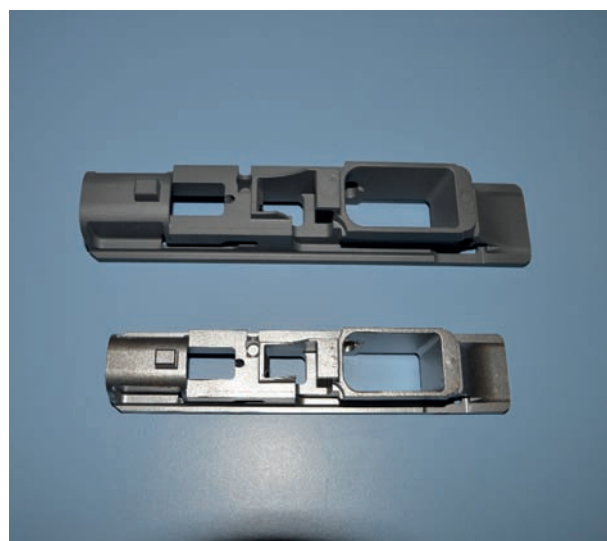
Rys. 10. Element stalowy produkowany przez firmę MIMECRI S.A. po formowaniu wtryskowym oraz spiekaniu
