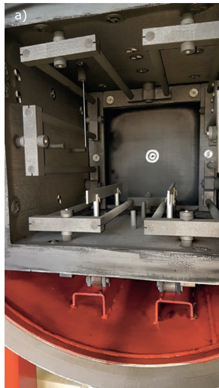
Rys. 2. Komora: a) grzania z widoczną śluzą między komorami, elementami grzewczymi, termoelementami oraz podporami grafitowymi, na których jest osadzana matryca przez system transportu; b) załadunkowa/chłodzenia z widoczną śluzą między komorami, systemem transportu i molibdenową matrycą na której umieszcza się wsad oraz wannę olejową
