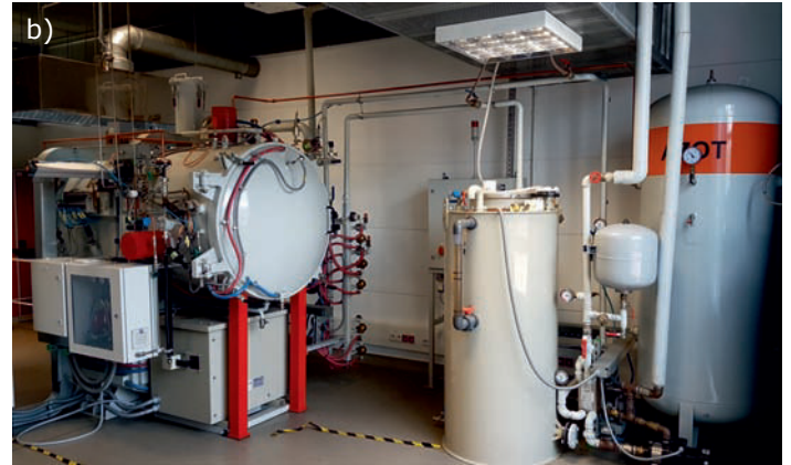
Rys. 1. Dwukomorowy piec próżniowy z systemem hartowania w oleju oraz systemem nawęglania próżniowego CaseMaster Evolution D4 firmy Seco/Warwick: a) urządzenie wraz z szafą zasilania i sterowaniem; b) urządzenie wraz z systemem nawęglania, chłodzenia oraz zbiornikiem buforowym gazu obojętnego
