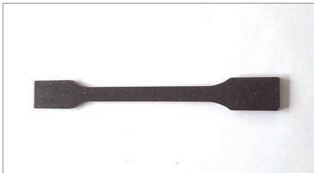
Rys. 3. Próbka wytworzonego kompozytu PP/mączka z orzechów laskowych
