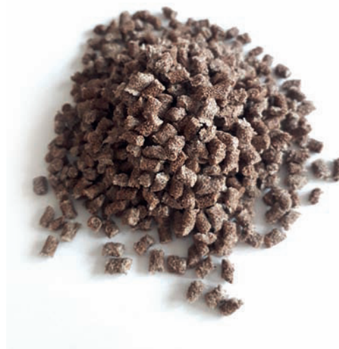
Rys. 2. Zdjęcie wytworzonego granulatu PP z mączką z orzechów laskowych
