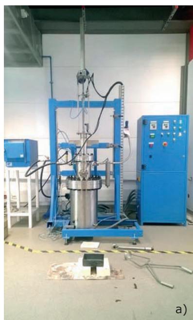
Rys. 1. Urządzenie do infiltracji gazowo-próżniowej: a) zdjęcie, b) schemat
