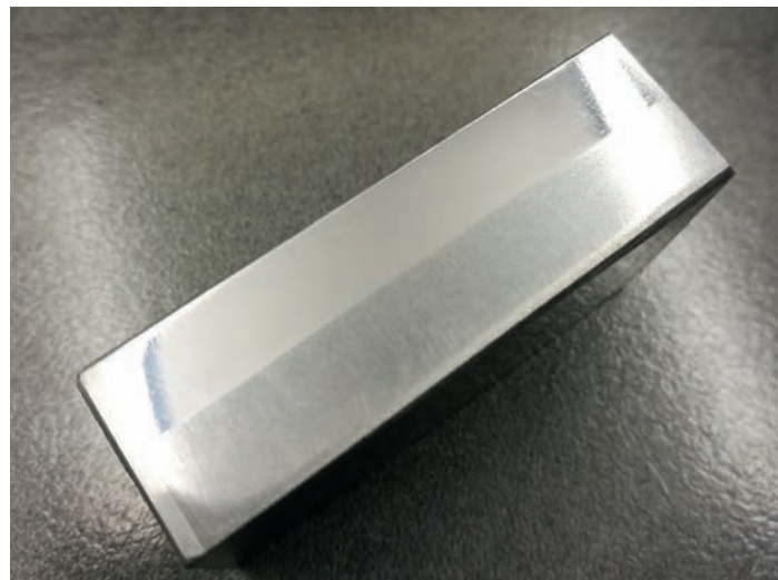
Rys. 7. Lokalnie wzmocniany szkieletem Al_2O_3 odlewu ze stopu EN AC- AlSi12
