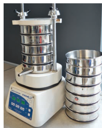
Rys. 3. Wytrząsarka wibracyjna z kompletem sit VWR – Haver EML 200 digital
