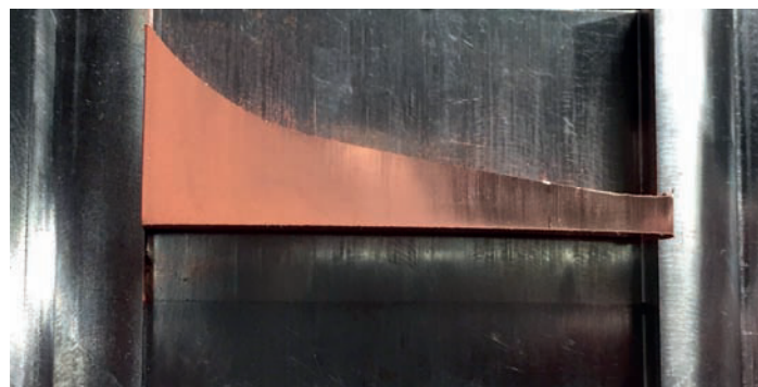
Rys. 7. Wynik badania formowalności proszku miedzi
