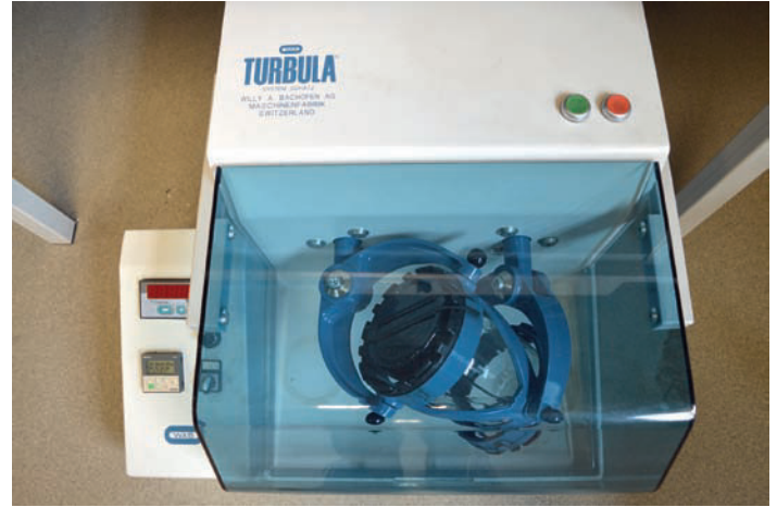
Rys. 10. Mieszalnik turbulentny Turbula T2F
