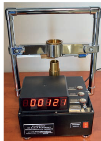
Rys. 4. Stanowisko do badania sypkości proszku
