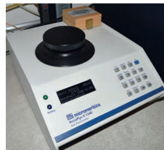
Rys. 2. Piknometr helowy AccuPyc 1340
