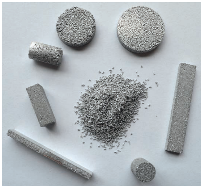
Rys. 6. Przykładowe wypraski z proszku aluminium o średniej wielkości ziarna 0,8 mm
