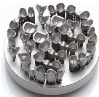
Rysunek 3. Korony oraz mosty wielopunktowe po spiekaniu SLM [15]
