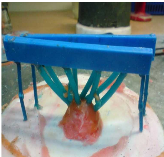
Rysunek 3. Powielona próbka wzorcowa przed procesem odlewania [5] Figure 3. Duplicated standard sample before casting proces [5]
