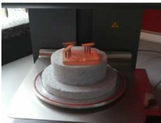
Rysunek 2. Próbkki w piecu w czasie wypalania ceramiki
