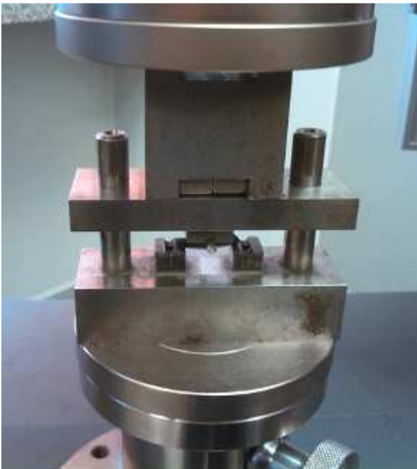
Rysunek 4. Badanie wytrzymałości na zginanie dla wytworzonych próbek Figure 4. Bending testing for prepared specimens
