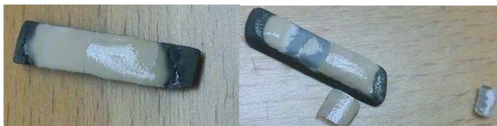
Rysunek 6. Próbki po badaniu wytrzymałościowym z widocznymi uszkodzeniami Figure 6. Samples after strenght tests with visible damages
