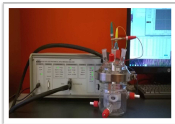
Rysunek 3. Stanowisko do badań elektrochemicznych ze schematem potencjostatu elektrochemicznego w naczyniu pomiarowym
