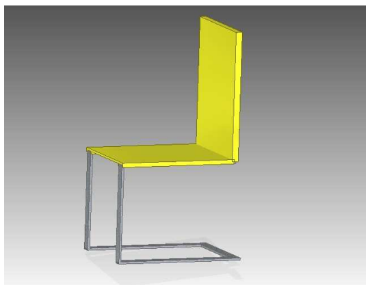
Rysunek 2. Geometryczny model krzesła (kolor żółty – siedzisko i oparcie wykonane z polipropylenu)
