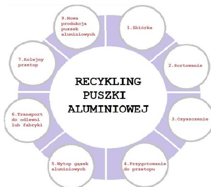
Rysunek 6. Schemat przebiegu recyklingu puszki aluminiowej [20]
