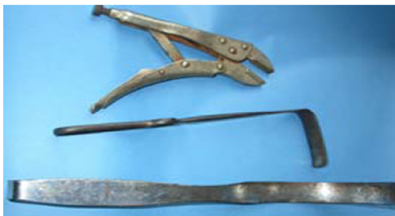
Rysunek 3. Stan narzędzi medycznych bez powłoki DLC po dłuższej eksploatacji [17] Figure 3. State of medical tools without coating DLC after a long life [17]
