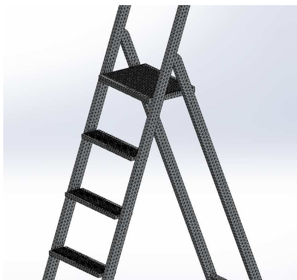
Rysunek 2. Modelu drabiny rozstawnej z nałożoną siatką elementów skończonych Figure 2. Mesh created for step ladder model
