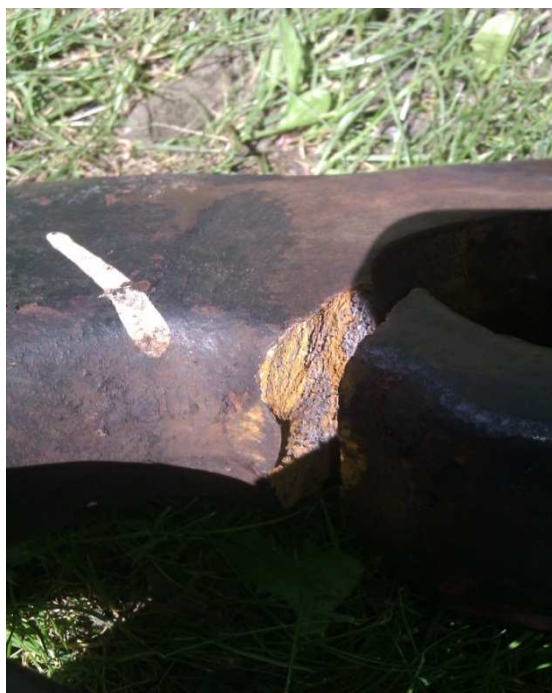
Rysunek 3. Pęknięcie haka w przekroju dolnego zaokrąglenia Figure 3. A crack of the hook in the lower round part
