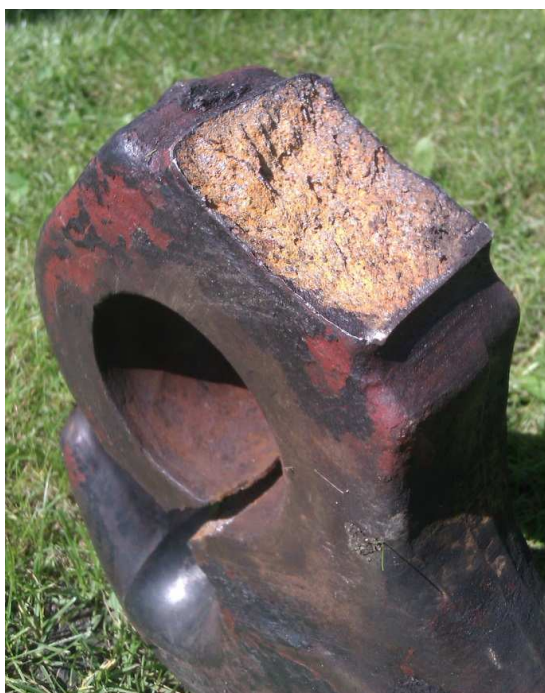
Rysunek 4. Całkowicie zerwany hak ciągowy oraz pęknięcie w przekroju dolnego zaokrąglenia Figure 4. A hook that's been completely torn apart in the lower round part
