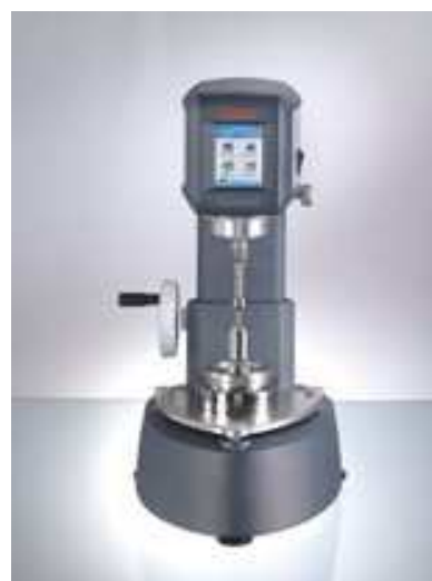
Rysunek 1. Schemat wiskozymetru obrotowego Thermo Scientific™ HAAKETM Viscotester™ iQ
