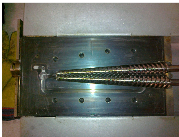
Rysunek 2. Ślimaki do pracy przeciwbieżnej znajdujące się w pozycji roboczej Figure 2. Screws for counter-extrusion mode in the working position
