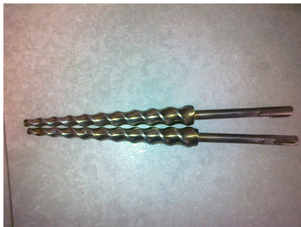
Rysunek 1. Ślimaki do pracy współbieżnej po wyjęciu z urządzenia Figure 1. Screws for co-extrusion mode removed from the device
