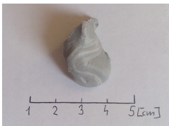
Rysunek 5. Próbką W1 pobrana po wytłoczeniu wsadu – tryb współbieżny pracy ślimaków Figure 5. Sample W1 taken after co-extrusion mode of screw work
