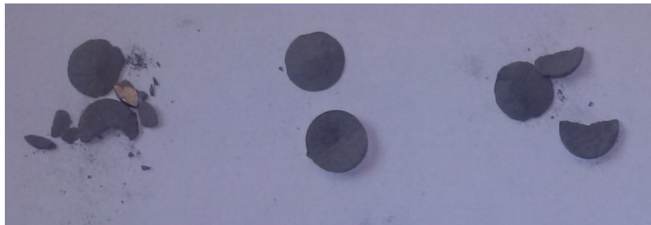
Rysunek 2. Wypraski o składzie 90% Ti 10% \mu wax po prasowaniu przy ciśnieniu w prasie: od lewej 50 bar, 100 bar, 200 bar
