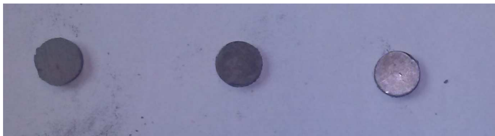
Rysunek 3. Wypraski o składzie 80% Ti 20% \mu wax po prasowaniu przy ciśnieniu w prasie: od lewej 50 bar, 100 bar, 200 bar
