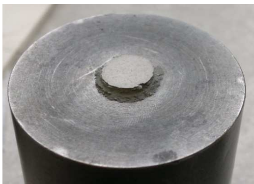
Rysunek 2. Wypraska proszku Co-Cr-Mo otrzymana przy ciśnieniu prasowania 1032 MPa Figure 2. Compact of the Co-Cr-Mo pre-alloyed powder obtained at the pressure 1032 MPa
