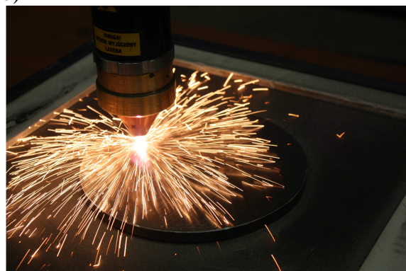
Rysunek 3. Proces napawania laserowego ze współosiowym podawaniem materiału dodatkowego Figure 3. The view of laser hardfacing process
