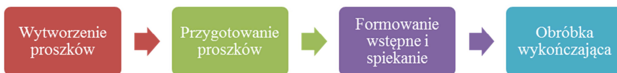
Rysunek 1. Uproszczony schemat wytwarzania wyrobów metodą metalurgii proszków [1] Figure 1. A simplified diagram the production of products by powder metallurgy
