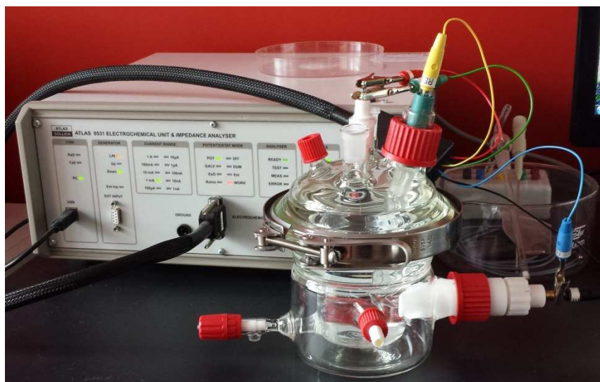
Rysunek 2. Stanowisko do badań elektrochemicznych składające się z potencjostatu oraz naczynka elektrochemicznego
