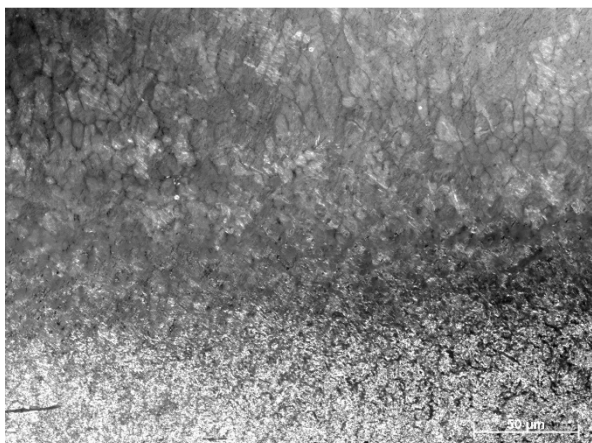
Rysunek 7. Struktura przetopienia i strefy wpływu ciepła, moc lasera 500 W
