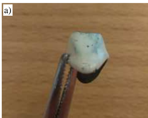
Rysunek 5. Warstwa opakera na metalowym podłożu: a) po naniesieniu, b) po napaleniu w piecu Figure 5. Opaque layer on a metal base :a) after opaque application, b ) after firing in the furnace
