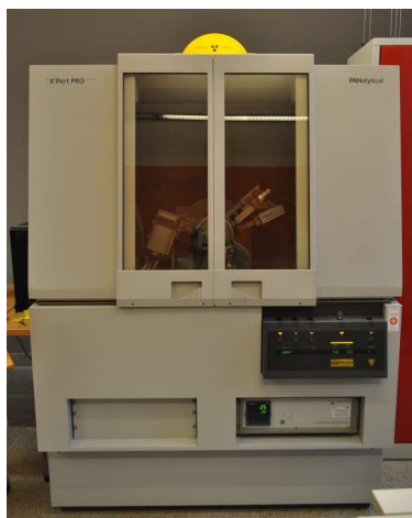
Rysunek 13. Zdjęcie dyfraktometru rentgenowskiego X'Pert PRO firmy PANalytical Figure 13. Photo of X'Pert PRO X-ray diffractometer of PANalytical company
