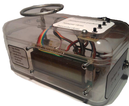
Rysunek 6. Wykonany układ czujnika kąta obrotu kierownicy
