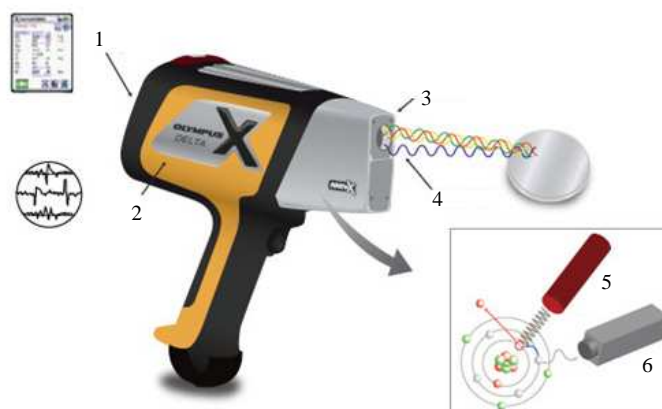
Rysunek 1. Schemat analizatora XRF Olympus Delta Premium: 1 – wyświetlacz, 2 – procesor, 3 – detektor, 4 – lampa rentgenowska, 5 – lampa, 6 – detektor [6]
