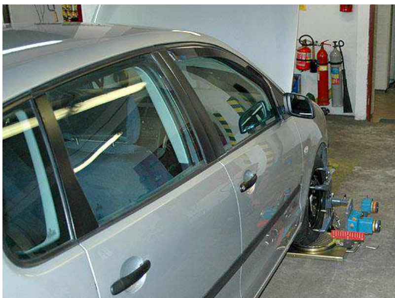
Rysunek 2. Laserowa geometria zawieszenia Figure 2. Laser suspension geometry
