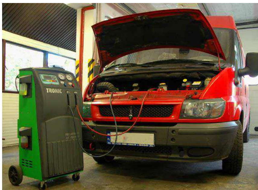
Rysunek 3. Przykład serwisu klimatyzacji Figure 3. Example of air conditioning service
