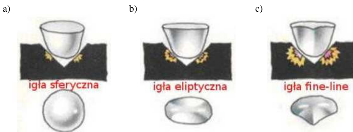
Rysunek 1. Typy igieł gramofonowych: a) sferyczna, b) eliptyczna, c) fine-line [7]
