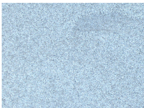
Rysunek 8. Topografia powierzchni przed badaniem, stal X6Cr13, pow. 10x Figure 8. Surface topography before testing, of steel X6Cr13, mag. 10x
