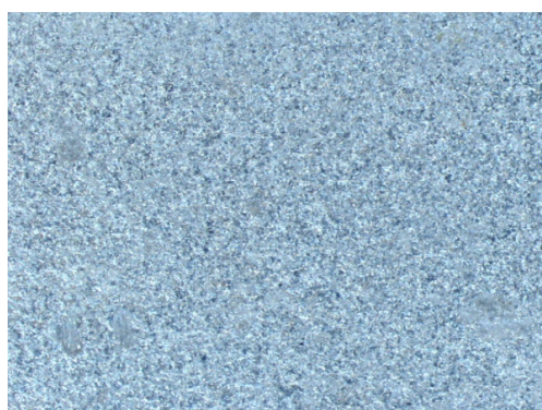
Rysunek 13. Topografia powierzchni po badaniu, stal X2CrNiMo22-8-2, pow. 10x Figure 13. Surface topography before testing, of steel X2CrNiMo22-8-2, mag. 10x
