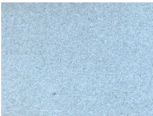
Rysunek 16. Topografia powierzchni przed badaniem, stal X2CrNiMo17-12-2, pow. 10x Figure 16. Surface topography before testing, of steel X2CrNiMo17-12-2, mag. 10x
