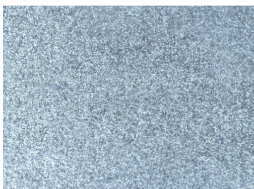
Rysunek 12. Topografia powierzchni przed badaniem, stal X2CrNiMo22-8-2, pow. 10x Figure 12. Surface topography before testing, of steel X2CrNiMo22-8-2, mag. 10x
