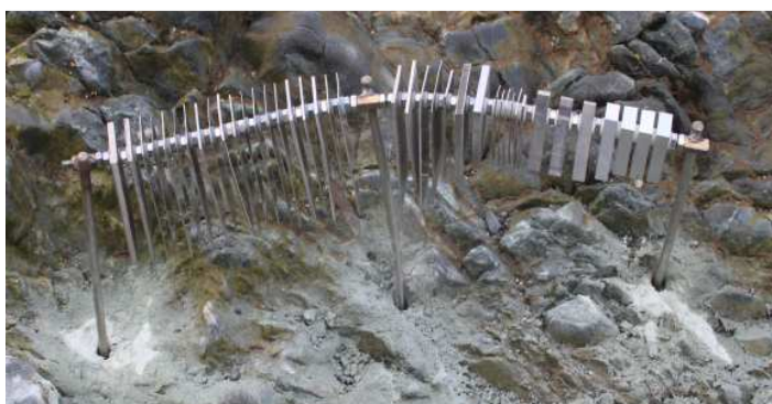
Rysunek 1. Statyw z próbkami do badań
