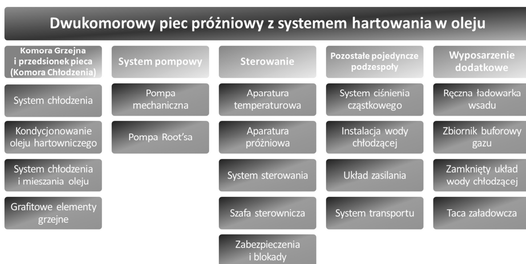
Rysunek 4. Schemat blokowy części składowych dwukomorowego pieca próżniowego z systemem hartowania w oleju CaseMaster Evolution D4 firmy Seco/Warwick
