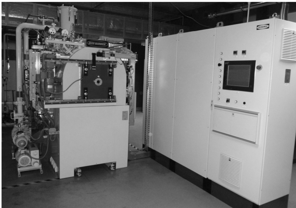
Rysunek 2. Dwukomorowy piec próżniowy z systemem hartowania w oleju CaseMaster Evolution D4 firmy Seco/Warwick wraz z szafą sterowniczą
