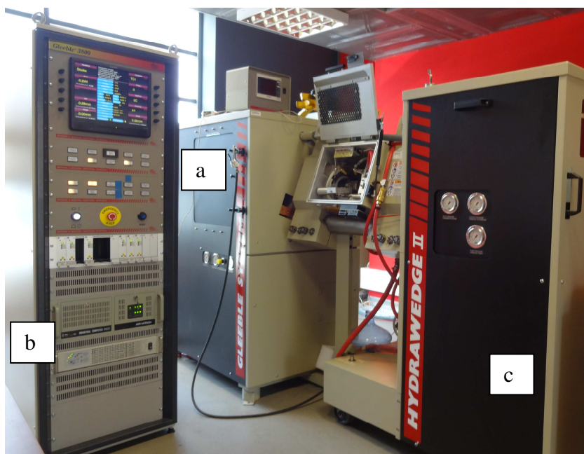
Rysunek 1. Symulator obróbki cieplno-plastycznej Gleeble 3800 wraz z modułem Hydrawedge Figure 1. Gleeble 3800 thermo-mechanical simulator with Hydrawedge unit
