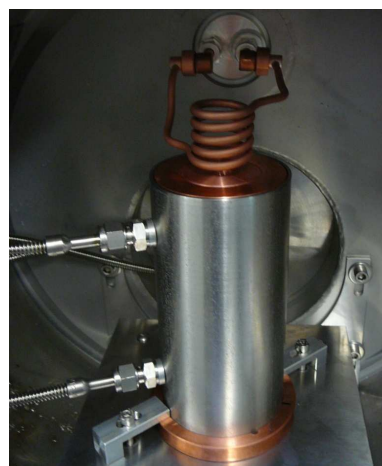
Rysunek 4. Miedziana forma do odlewania prętów amorficznych Figure 4. The copper mold for amorphous rods casting
