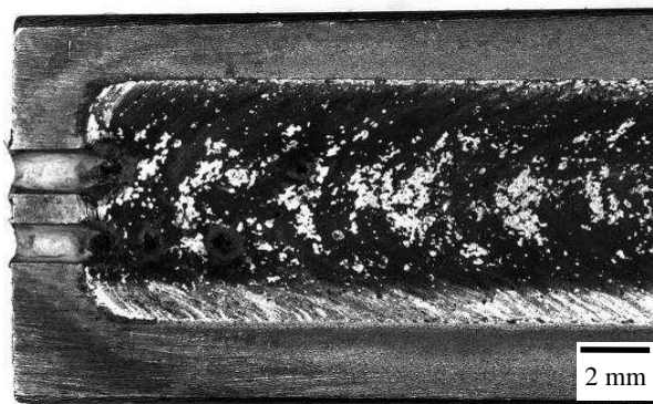
Rysunek 7. Widok lica przetopienia warstwy wierzchniej stali X2CrNiMo17-12-2 stopowanej Si 3 N 4 ; 2 rowki o głębokości 1 mm, moc lasera 2.1 kW, prędkość skanowania 0.3 m/min; początek przetopienia
