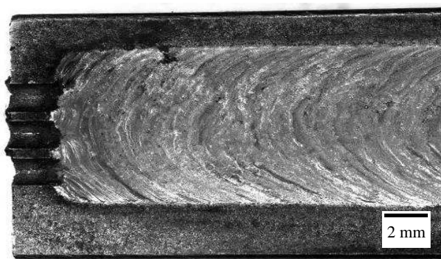
Rysunek 8. Widok lica przetopienia warstwy wierzchniej stali X2CrNiMo22-8-2 stopowanej SiC; 3 rowki o głębokości 1 mm, moc lasera 2.1 kW, prędkość skanowania 0.3 m/min; początek przetopienia
