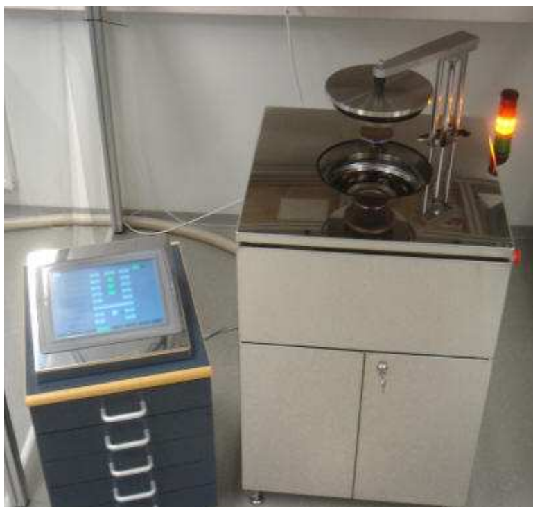
Rysunek 2. System R-200 do osadzania powłok metodą atomowego osadzania warstw firmy Picosun
