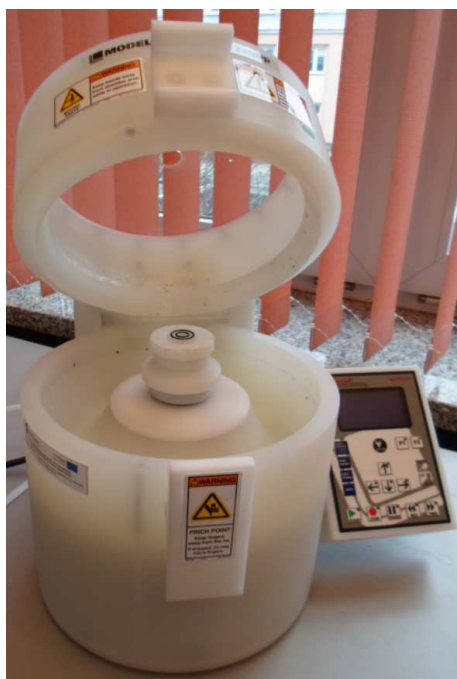
Rysunek 3. Urządzenie WS-650 do nanoszenia cienkich warstw metodą wirową Figure 3. The WS-650 device to deposit thin film by spin coating method
