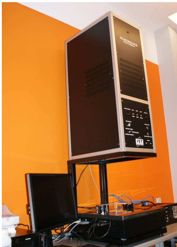
Rysunek 1. Stanowisko do pomiaru charakterystyk prądowo-napięciowych ogniw SS I-V CT-02
