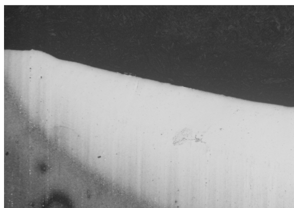
Rysunek 6. Brzeg przetopienia warstwy wierzchniej stali HS6-5-2 po laserowym przetopieniu; gęstość mocy wiązki 2,0 kW; pow. 500x
