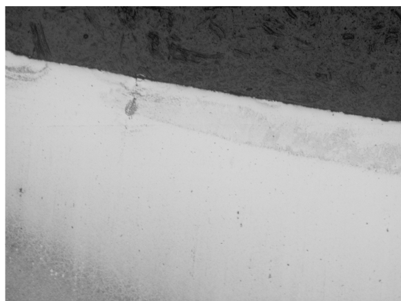
Rysunek 5. Brzeg przetopienia warstwy wierzchniej stali HS6-5-2 po laserowym przetopieniu; gęstość mocy wiązki 1,4 kW; pow. 1000x
