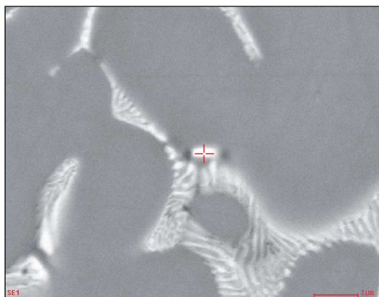
Rysunek 16. Warstwa środkowa stali szybkoznanej HS6-5-2 po laserowym przetapianiu przy mocy wiązki 1,7 kW, WC coating (SEM)
