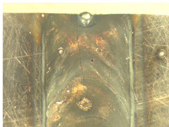
Rysunek 3. Lico przetopienia stali HS6-5-2 w fazie początkowej przetapiania; gęstość mocy wiązki 2,0 kW; WC
