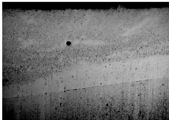
Rysunek 9. Warstwa wierzchnia stali HS6-5-2 po laserowym przetopieniu; gęstość mocy wiązki 1,7 kW, WC pow. 1000x
