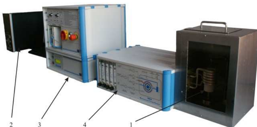
Rysunek 1. Aparatura UMSA: 1 - komora badawcza, 2 - komputer sterujący, 3 - generator wysokiej częstotliwości, 4 - moduł sterujący przepływem gazu
