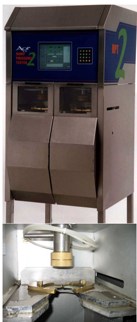
Rysunek 4. Widok ogólny a) oraz schemat działania b) urządzenia do badań wytrzymałości na ciśnienie wewnętrzne (1 – pulpit sterowniczy, 2 – głowica, 3 – próbka, 4 – przewód zasilający
