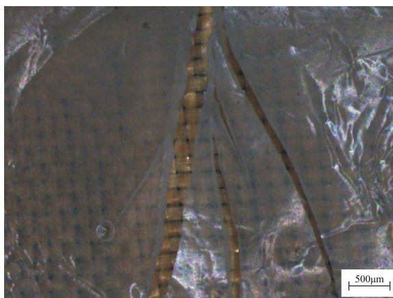
Rysunek 9. Obraz próbki wzmacnianej tkaniną aramidową po modyfikacji Fibrosilem W Figure 9. The image samples of reinforced aramid fabric after Fibrosil W preparation
