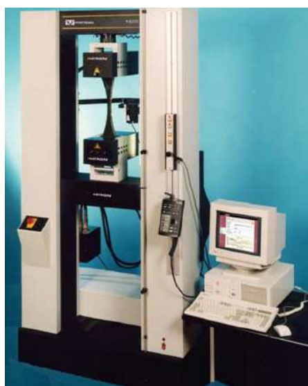
Rysunek 3. Uniwersalna maszyna wytrzymałościowa Instron 4505 o maksymalnej sile 100 kN [19]
