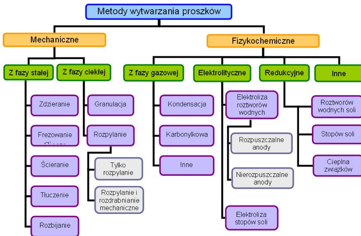
Rys. 3. Klasyfikacja metod wytwarzania proszków [2]
