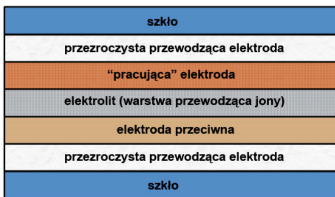
Rys. 3. Warstwy szyby elektrochromatycznej [1]
