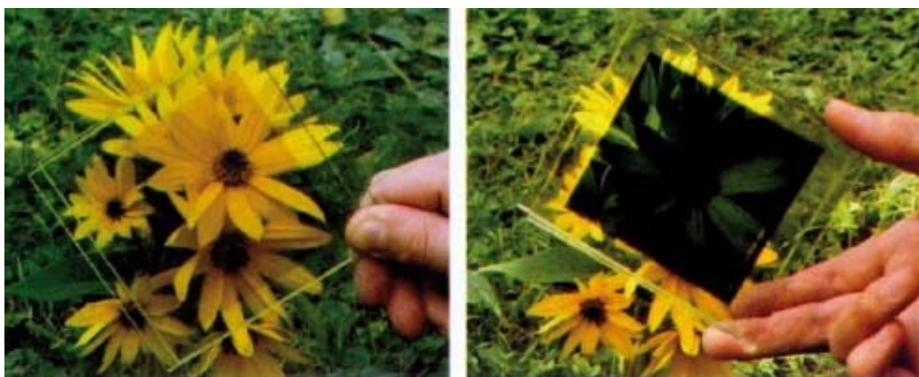
Rys. 13. Próbkki szklenia fotochromatycznego opracowanego w Instytucie Fraunhofera [3]
